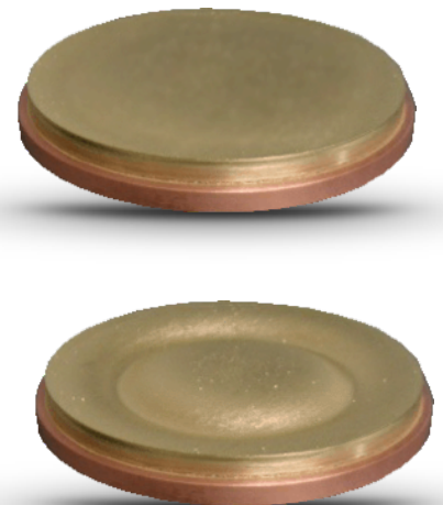
gebondete Targets vor und nach dem Gebrauch bonded targets before and after use
