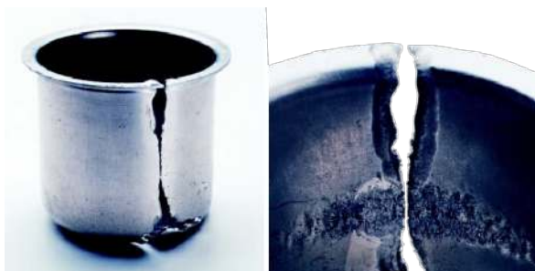
Abb.1. lokaler Aufschmelzdefekt verursacht durch SiC Fig.1 Local reflow defect caused by SiC
